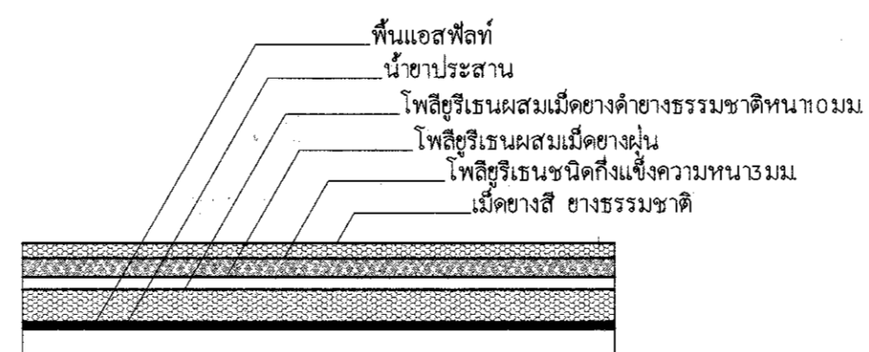
แบบขยายการทำผิวพื้นลู่วิ่งและลานกรีฑา (Sandwich System)
